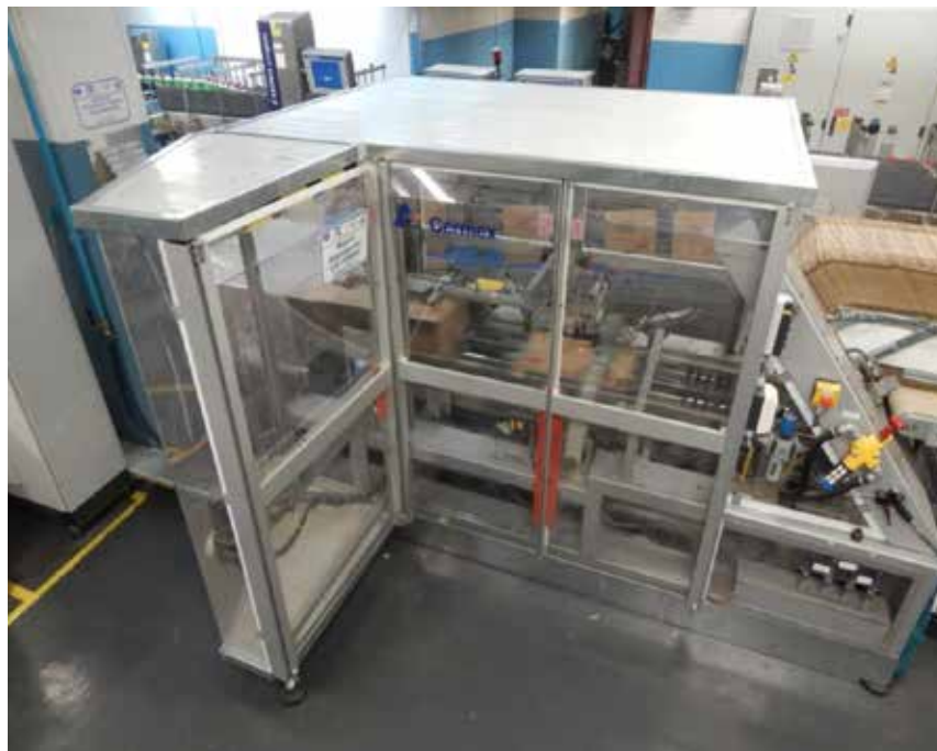
Ηχομονωτικό διαφανές κάλυμμα σε διπλωτική μηχανή χαρτοκιβωτίων
