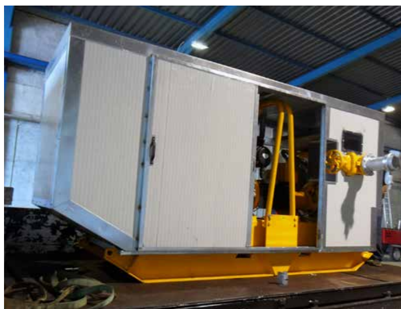
Ηχομόνωση φορητής πετρελαιοκίνητης αντλίας
